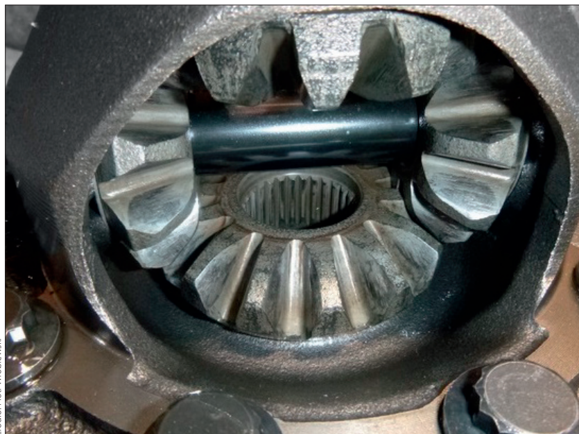
▲ Ilustracja 2. Wnętrze mechanizmu różnicowego. Satelity osadzone na wałku otaczają się po kołach koronowych.
