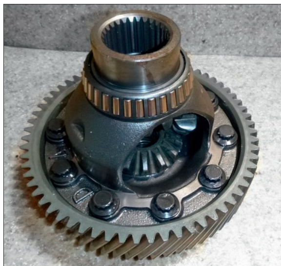
▲ Ilustracja 1. Mechanizm różnicowy zamontowany w obudowie, której przykręcone jest koło walcowe z zębami skośnymi. To na nie przekazywany jest napęd ze skrzyni biegów.
